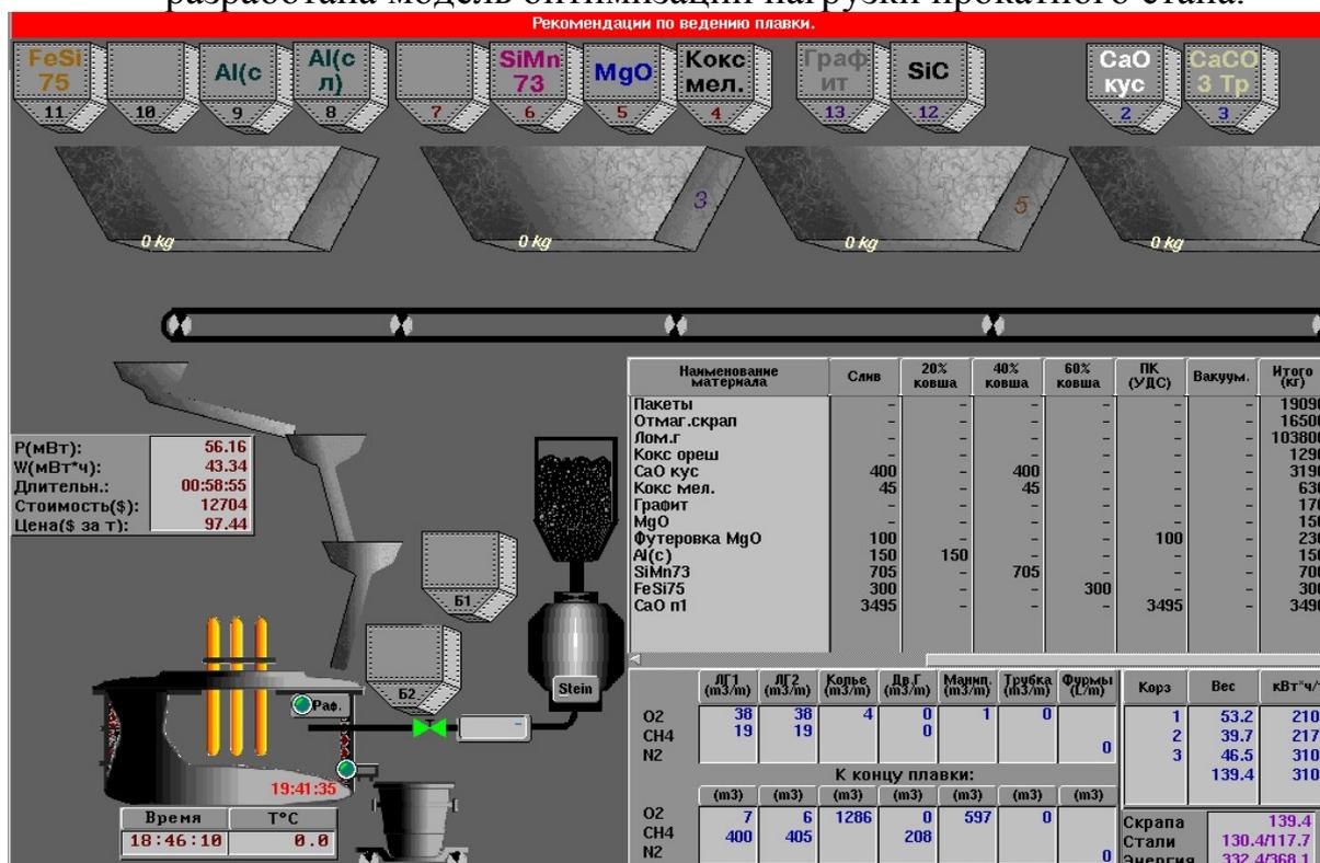
Рисунок 3 – Фрагмент работы системы моделирования выплавки и внепечной обработки стали.
